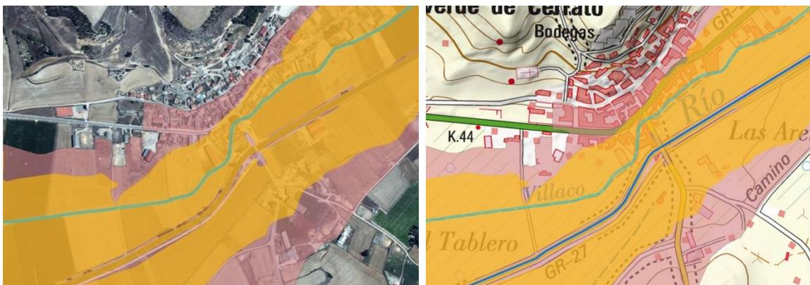
**Ilustración 52:** El efecto, sobre el territorio, del Cambio Climático (RCP's 8.5), sobre el esgueva. Como se ve, la topografía ejerce un control estructural muy importante. A la derecha, con base en el catastro, se definen las zonas expuestas de Vulnerabilidad y Sensibilidad.
